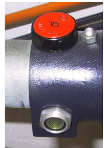
Schauglas für Ölstandkontrolle
